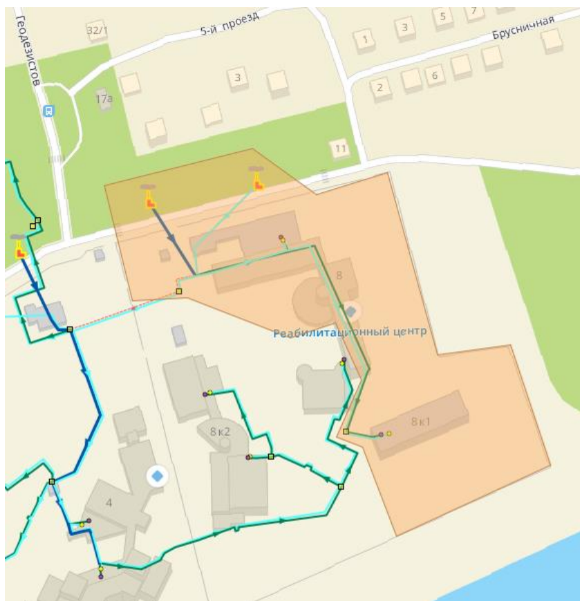
Рисунок 4.22 – Зона действия котельной №32 п. Снежный СГМУП «ГТС»
