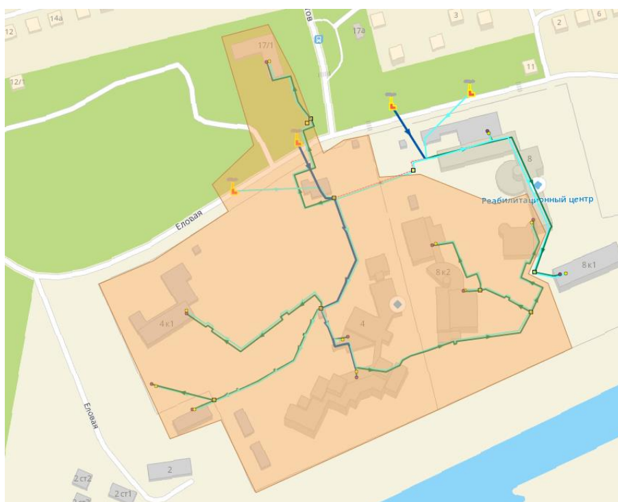
Рисунок 2.23 – Зона действия котельной №33 п. Снежный СГМУП «ГТС»
